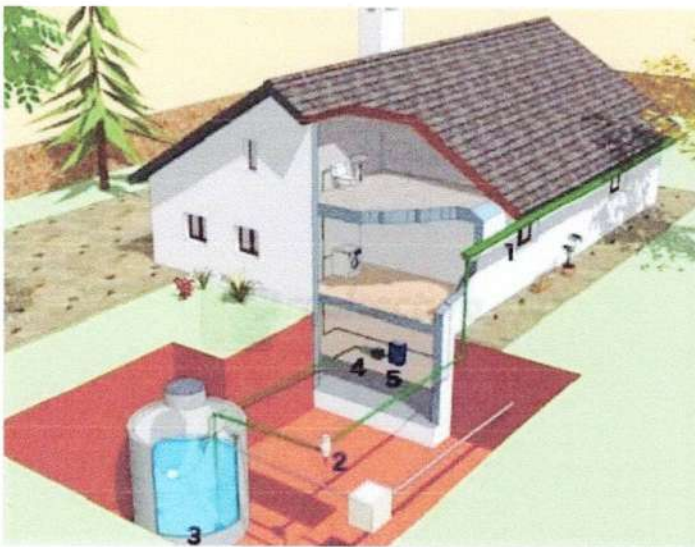
Ilustración 4: Captación de aguas
